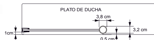
Dibujos técnicos FL633 Panel Fijo de Ducha a Techo
